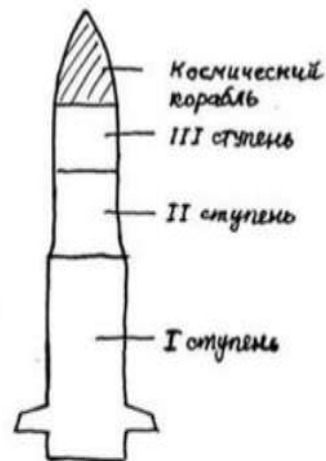
Устройство многоступенчатых ракет
