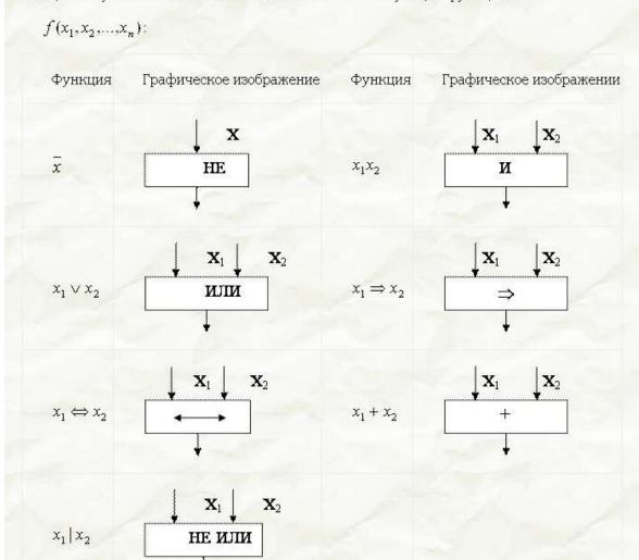
Из данных логических элементов путем соединения входа одного из них с выходов другого можно строить все более сложные логические схемы. Для полученных таким образом схем легко записывают соответствующие им булевы функции.
