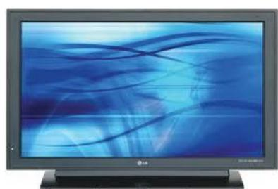
Экран ГП монитора также содержит матрицу, но ячейки заполнены газовой смесью (неоном или ксеноном (реже гелий и/или аргон, или, чаще, их смеси). Газ светится под воздействием электрического тока: при подаче напряжения происходит разряд, инертный газ испускает фотоны, которые бомбардируют фосфорное покрытие ячейки, фосфор в свою очередь начинает испускать фотоны света.
