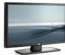
Дисплей с такой панелью не только тонкий, но и поддерживает большую яркость (единица измерения силы света - кандела), а изображение на нем хорошо различимо даже в освещенной комнате. Сейчас подобные экраны используются главным образом как информационные табло в больших, хорошо освещенных помещениях, на-
