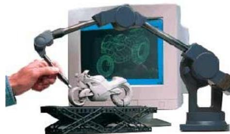
**Лазерные дигитайзеры** - полностью автоматизированные системы, обладают самой высокой точностью, но область их применения имеет значительные ограничения (блестящие, зеркальные или прозрачные поверхности объекта покрываются антибликовым составом, создающим белую матовую поверхность пригодную для оптического сканирования).
