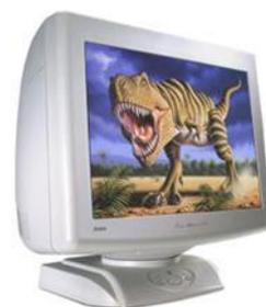
Для того, чтобы подсвечивать три зерна пикселя, потребуется сразу три электронных пушки, и каждая из них должна излучать поток электронов в направлении своего зерна. Чем меньше зерна люминофора экрана и больше плотность, тем выше четкость изображения и утомляемость глаз.
