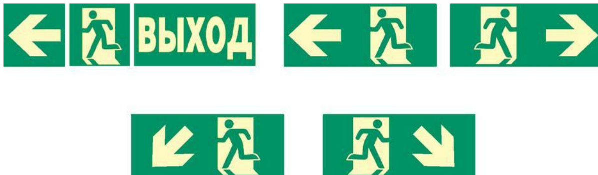
Рисунок 2 — Примеры знаков маршрутов эвакуации или указателей направления, которые допускается использовать вместе с текстом
