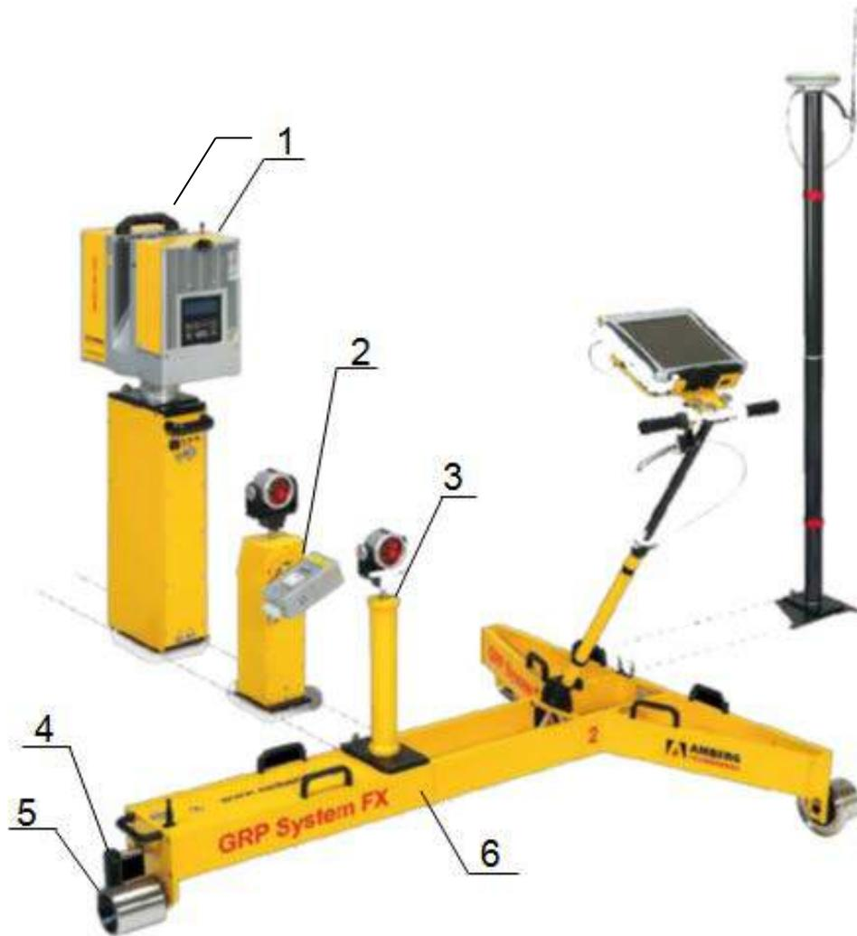
Рисунок 19 – Измерительная система **Amberg GRP System FX**
