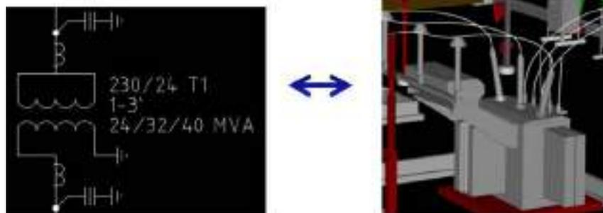
Рисунок 9 - Проектирование тяговых подстанций в ПК **Bentley**
