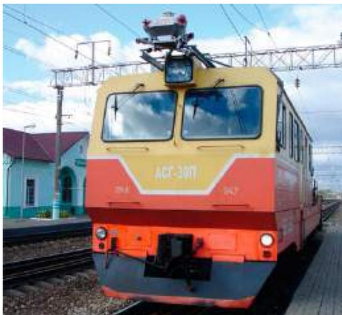
Рисунок 14 – Установка для выполнения мобильного лазерного сканирования
