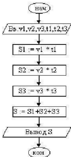
Пешеход шел по пересеченной местности. Его скорость движения по равнине  $v_1$  км/ч, в гору —  $v_2$  км/ч и под гору —  $v_3$  км/ч. Время движения соответственно  $t_1$ ,  $t_2$  и  $t_3$  ч. Какой путь прошел пешеход?
