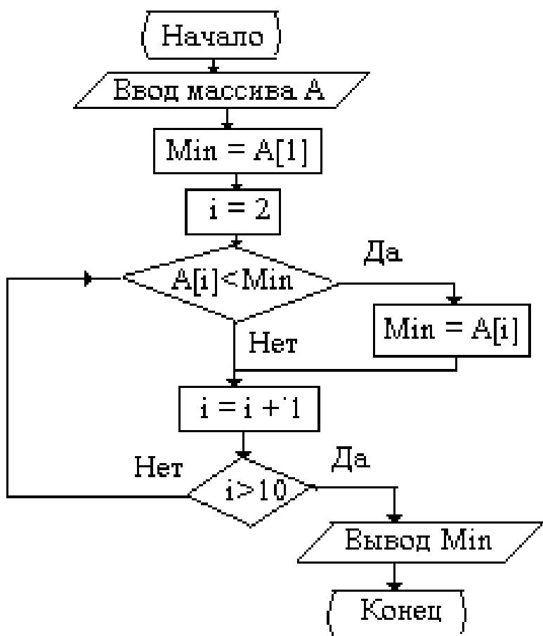
Рис. Блок-схема алгоритма поиска минимального элемента.
