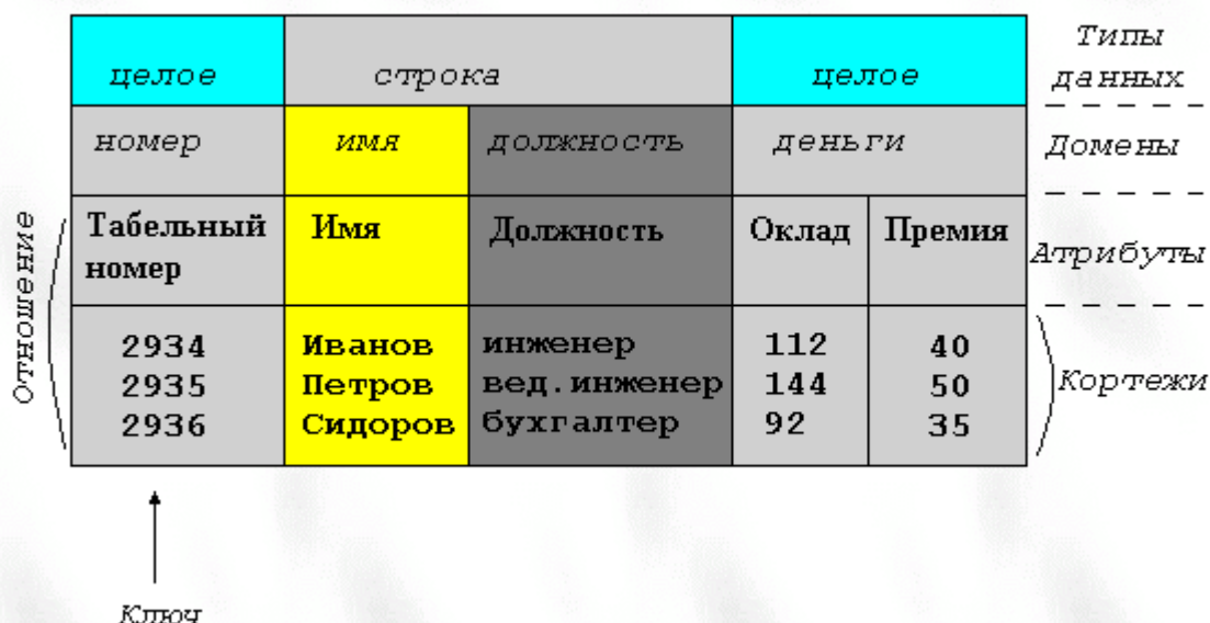
Рисунок 6. Основные компоненты реляционного отношения
