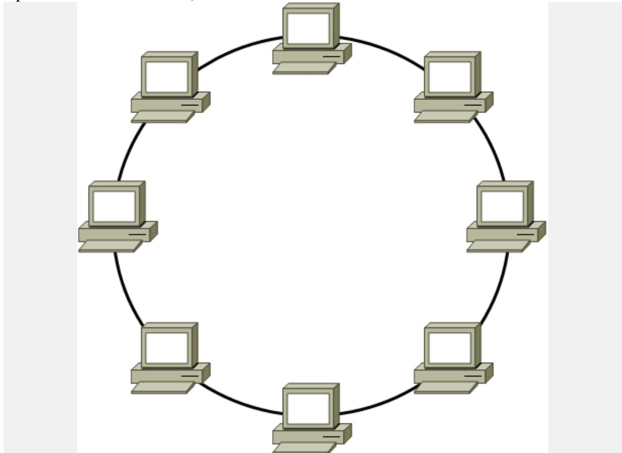
*Обычно компьютеры в кольцевой сети соединяли сразу двумя кабелями — один был основным, а другой — резервным*
