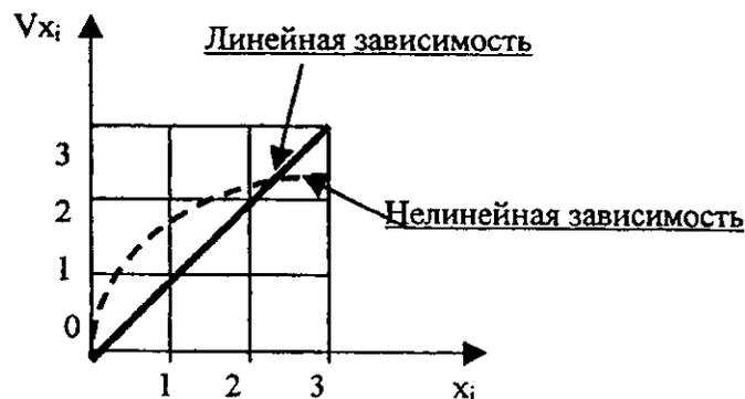
Рис. 5. Характер изменения общей производительности бригад в зависимости от их количества
