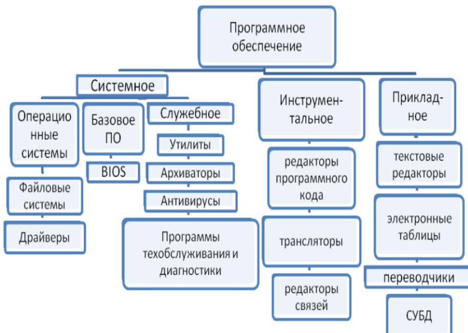
**Программное обеспечение (ПО)** - совокупность всех программ, предназначенных для выполнения на компьютере
