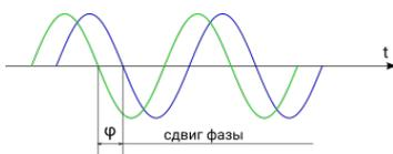
Мы можем принять, что у, например, синей синусоиды начальная фаза (начальный сдвиг) равна нулю. Тогда зеленая синусоида опережает синюю на угол  $\varphi$ . Или просто, сдвиг фазы между сигналами равен  $\varphi$ .
